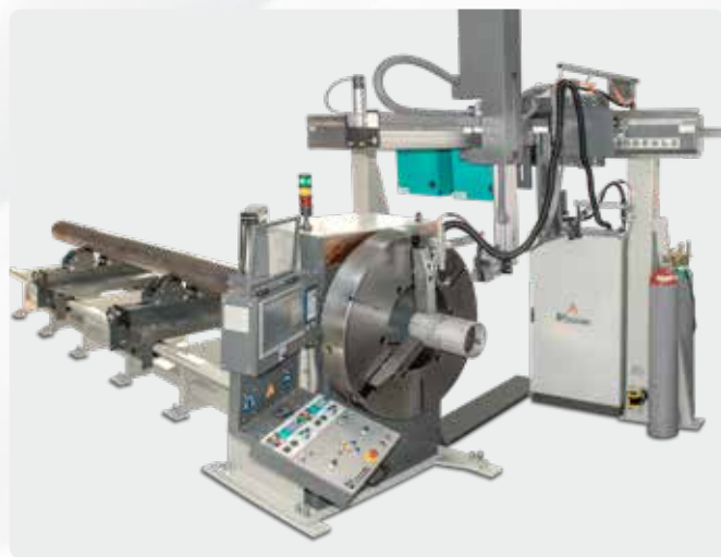
Rundnaht-Schweißanlage für lange Rohre mit einem Durchmesser von 150 bis 500 mm.
